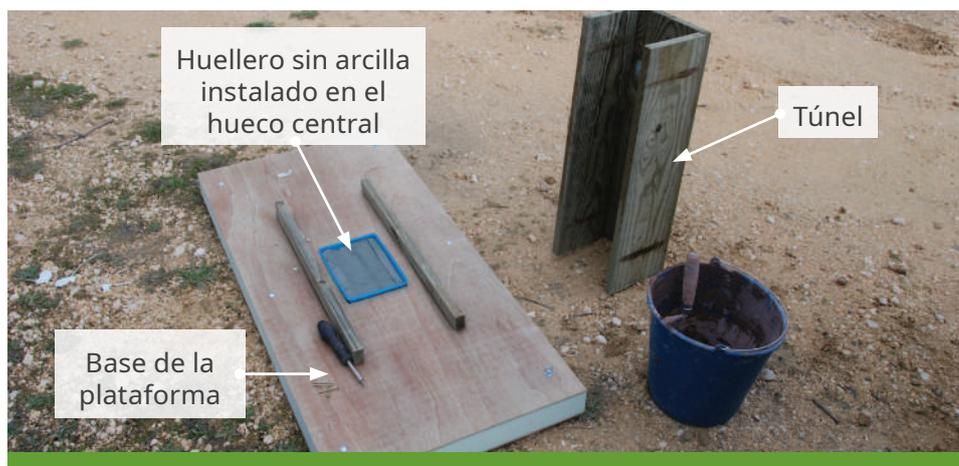
Figura 1. Plataforma flotante antes de su montaje final (antes de colocar el túnel y cubrir la esponja del hueller con la mezcla de arcilla refractaria y arena).
